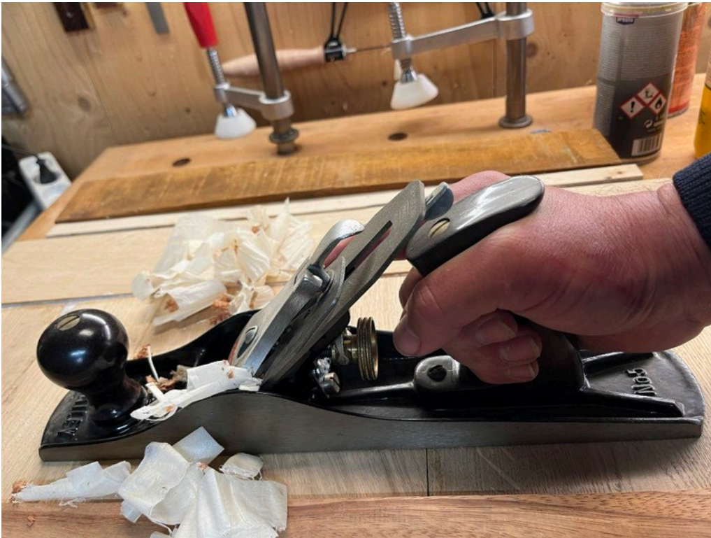
Abbildung eines Handhobels aus Metall, der zur Holzbearbeitung verwendet wird.
