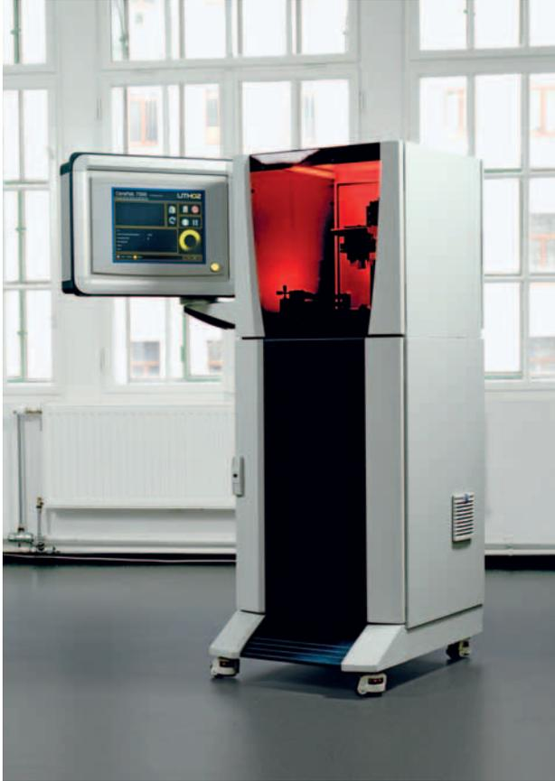
CeraFab 7500: System für additive Fertigung von Keramikteilen
